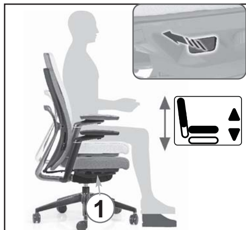
Réglage hauteur d'assise Seat height adjustment / Sitz Höhenverstellung
