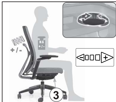
Réglage tension dossier Backrest tension adjustment Gewichtsregulierung
